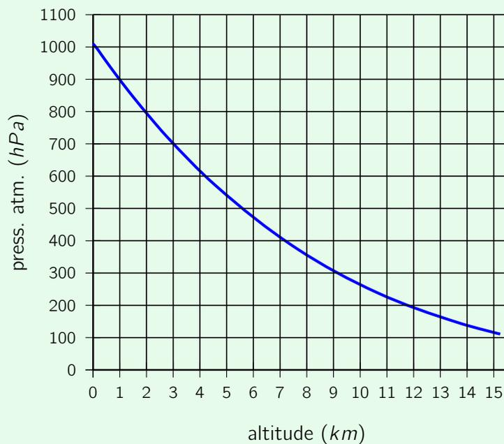
Cette variation de la pression avec l'altitude permet de ramener la mesure d'une altitude à une simple mesure de la pression atmosphérique. Dans les avions, on utilise ainsi des baromètres qui indiquent directement l'altitude de vol. On les appelle alors *altimètres*.
